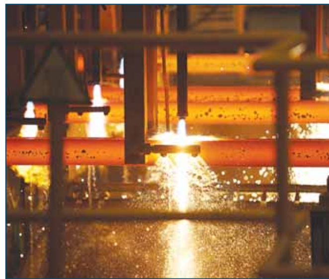
Резка заготовок на выходе из пром-ковша
