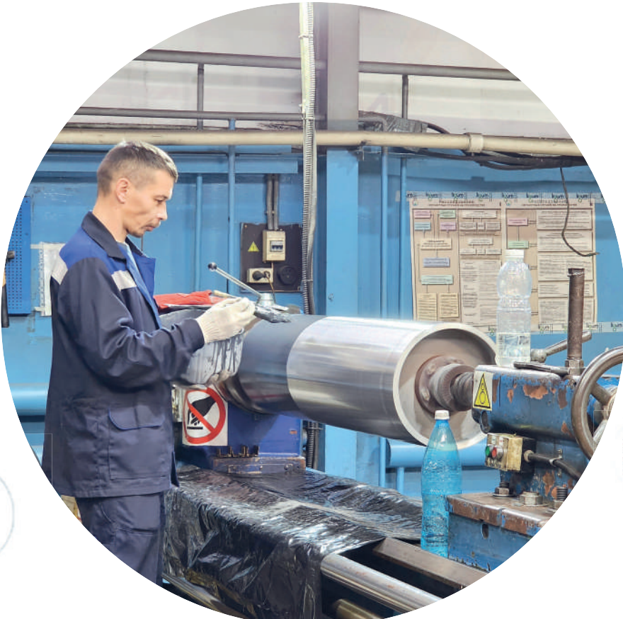
На заводе предусмотрен полный цикл производства. Здесь вал подготавливают к намотке, обезжиривают, наносят два слоя базового покрытия и клей, а затем наматывают резину
