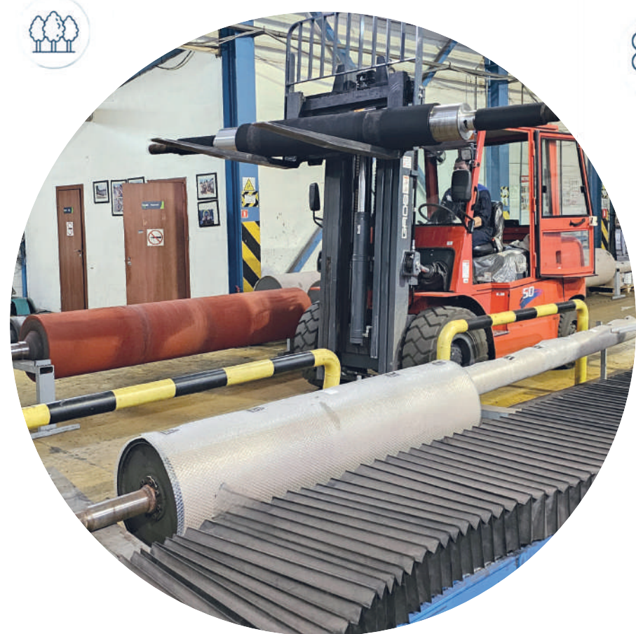
Между цехами валы перемещают с помощью крана-балки. Этот каток отправился на снятие резины
